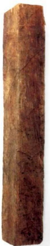
Corte de madera de coco de la albura (alta densidad) (IFRC-SRU).
