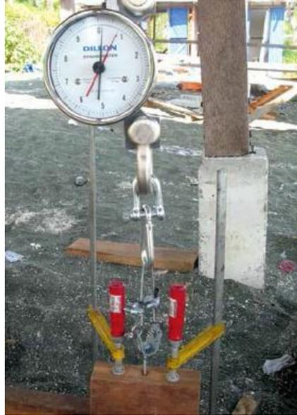
Samar Filipinas: Prueba para comprobar la resistencia al arranque en trozos de madera diferentes con la misma profundidad de penetración (IFRC-SRU).
